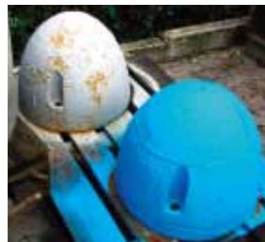
船のスクリューの芯に塗布した際の違い(6カ月) 青色=セラム・コート 白色=一般的塩害対策塗料 セラムには何ら変化がありませんが、従来の一般的な塩害対策塗料はサビがもれ出しています。
