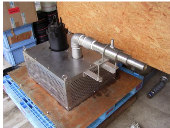
槽に投げ込むだけで稼働する水中型マイクロバブルYJ装置
